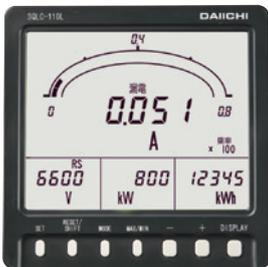
漏電電流計測画面
